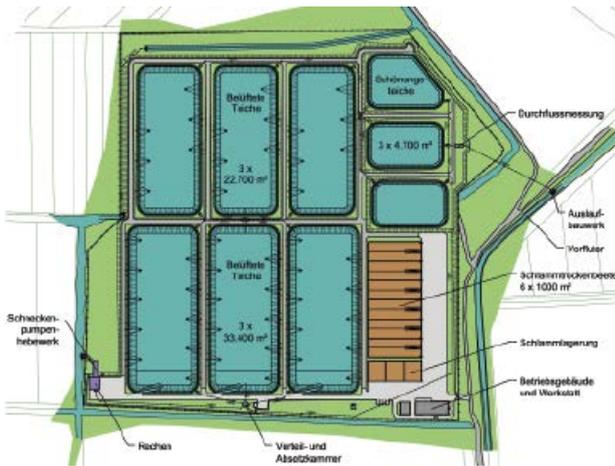
Abb. 4: Schematische Darstellung der Kläranlage
