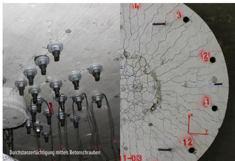
Durchstanzerdüchtigung mittels Betonschrauben
