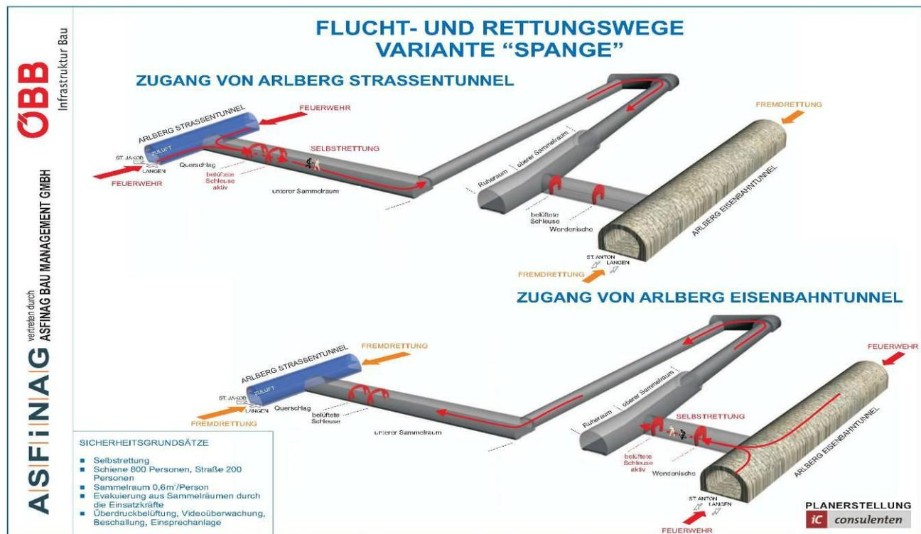
Aufgrund der unterschiedlichen Betreiber in den beiden Tunnelröhren ist es möglich, dass bei einer Flucht in die Querverbindung der Ausgang in den zweiten Tunnel noch nicht freigegeben ist. Um für diesen Fall ausreichend Sammelfläche für flüchtende Personen zur Verfügung zu haben, wurden Sammelräume errichtet.
