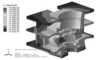
Abb. 5 Dynamische Berechnungen: Verformungen aus dynamischen Kräften
