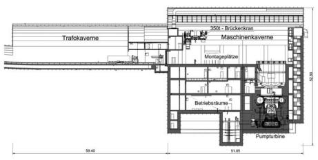
Abb. 1 Längsschnitt Maschinen- und Trafokaverne
