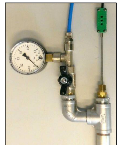
Abbildung 14: typischer Aufbau einer Messstelle (Druck & Temp.), hier inkl. zusätzlicher Druck-Analoganzeige
