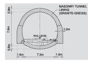
Fig. 2 Tunnel lining. Bild 2 Tunnelauskleidung.
