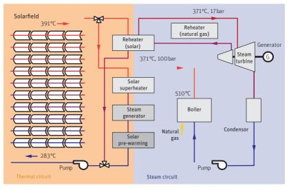
Figure 3.1.2.1: Schematic of a parabolic trough solar thermal power station (SEGS I-IV in California, USA). | Source: *Solarvorhaben – wirtschaftliche, technische und rechtliche Aspekte* by Jörg Böttcher, Oldenbourg Verlag 2011, Germany.
